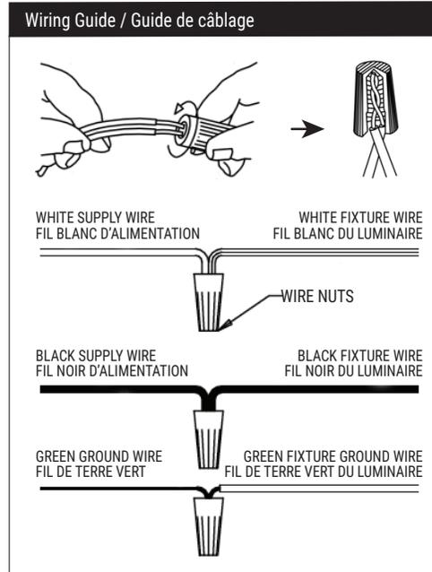
5. Mise à la terre: Utilisant le connecteur de fil (❺), fixer le fil de terre de la boîte de jonction (vert/cuivre) au fil de terre du luminaire (vert). Assurez que la connexion est sécurisée. **Important:** Si vous ne trouvez pas le fil de terre de la boîte de jonction, veuillez contacter votre électricien local pour les options de mise à la terre.
