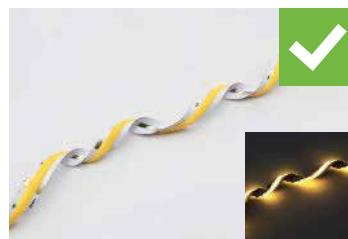
Le ruban COB possède un arrière plus résistant permettant de tordre le ruban sur un plus petit rayon que les autres modèles 24 V. Assurez-vous de maintenir en tout temps un rayon de torsion minimum de 0,8 po (20 mm).
